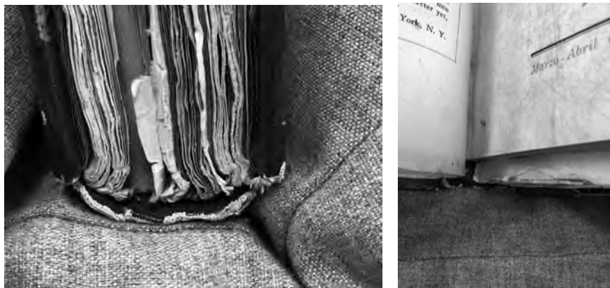
Figura 14. Efecto al pie de ejemplares de la revista Taller con diversos formatos, alineados a la cabeza para su encuadernación.
