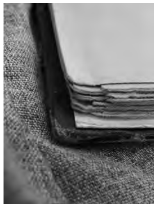
Figura 6. a) Papel estucado oxidado. b) Fibras desprotegidas debido a la pérdida de cargas.
